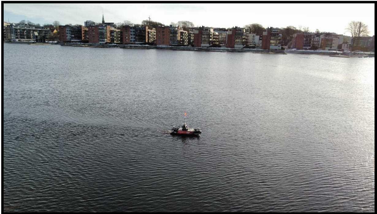
Figur 4: Otter USV under MBE kartlegging i Moss. Fjernstyrt fra land
