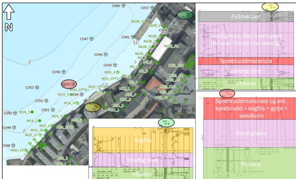
Figur 4-8: Sone 2 med et lite utvalg av borpunkt. Sprøbruddmateriale er påvist i dette området. Det opptrer fyllmasser hovedsakelig bestående av sagflis i område nært tilknyttet Fiskå Mølle (for eksempel ved punkt C071 med flere).
