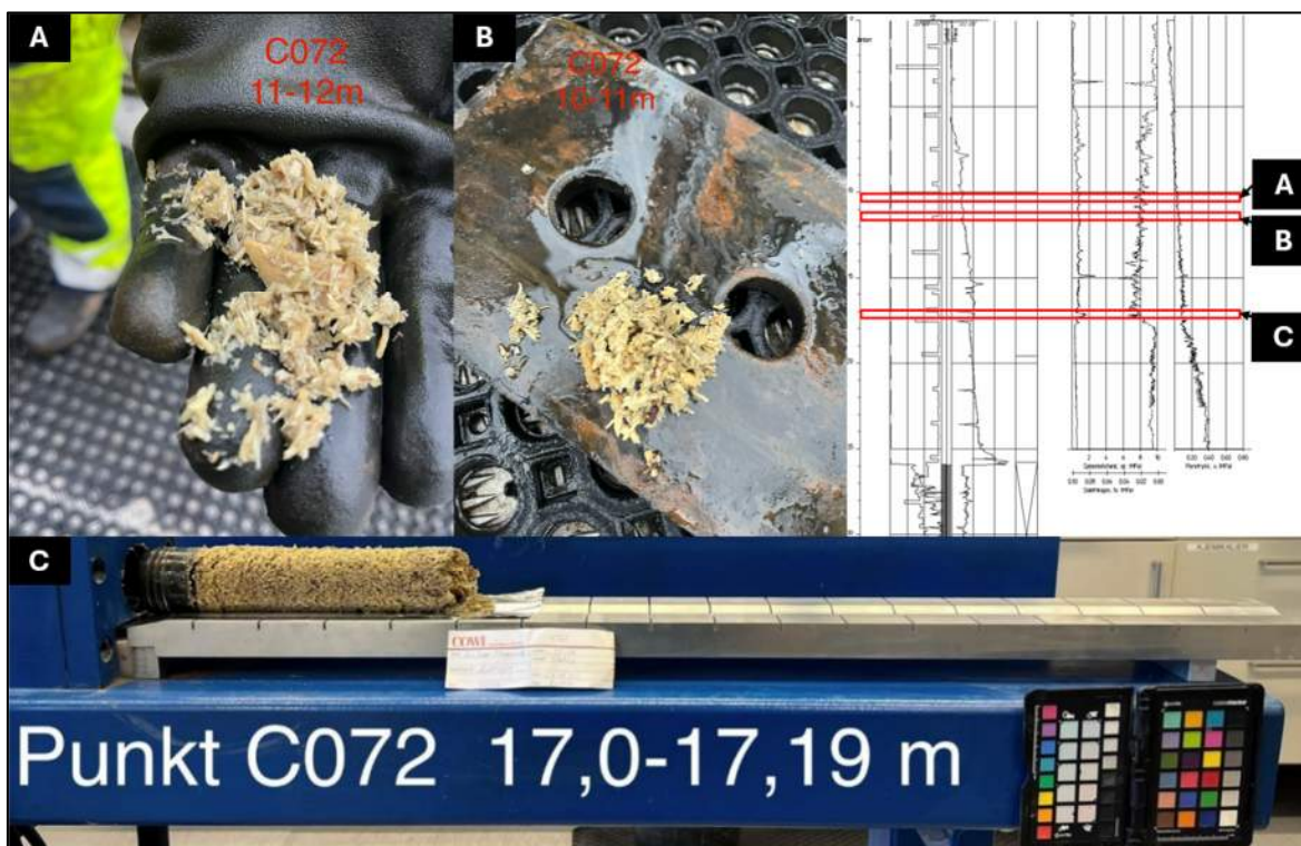
Figur 5-2: Utvalg fotografi fra felt og laboratorie. Sagflis opptrer på store dybder i området.
