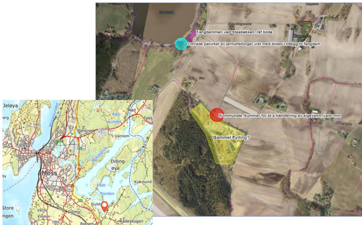
Figur 10 Det gamle deponiet er utviklet til næringsområde og store deler av området er fylt opp med andre masser. Eventuelt sigevann fra deponiet føres i rør til Støbekken sør, som går i rør under jorden nord for deponiet, og ned til Støbukta.
