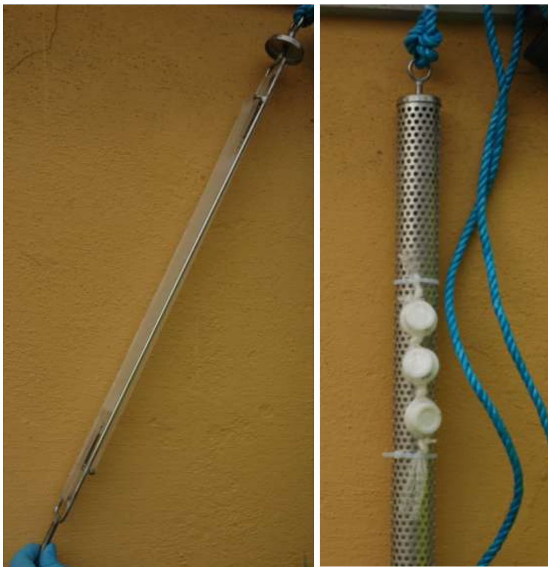
Figur 6. Passive prøvetakere. SPMD, 2 membraner spent opp (venstre bilde). SPMD-bur, 2 membraner montert inne i buret (høyre bilde). Buret er påmontert 3 DGTer.
