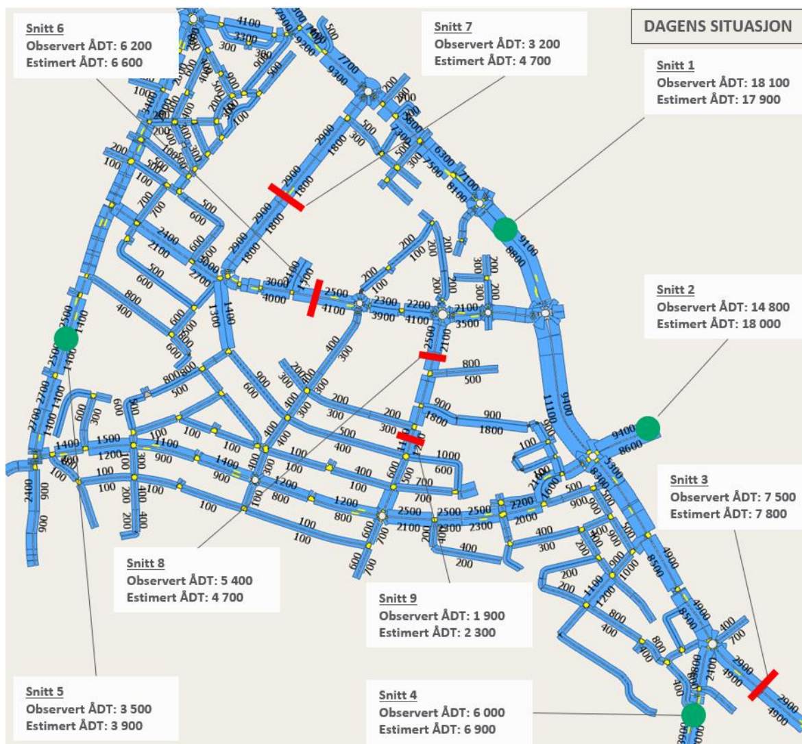
Figur 2-4. Beregnet ÅDT for dagens situasjon innenfor studieområdet (observert ÅDT) i snitt markert med røde linjer kommer fra Moss kommune; observert ÅDT i grønne punkter kommer fra eksisterende tellepunkter)
