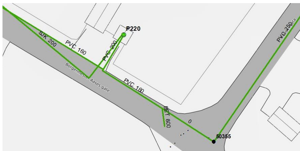
Figur 9: Ledningsstrek D er 160 PVC med beregnet kapasitet på 21 l/s.
