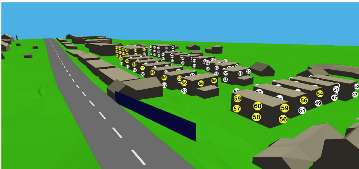
Figur 32: Innfallende lydtrykknivå L_{den} på fasader fra veitrafikk. Sett fra nord og vist med skjerpet grenseverdi
