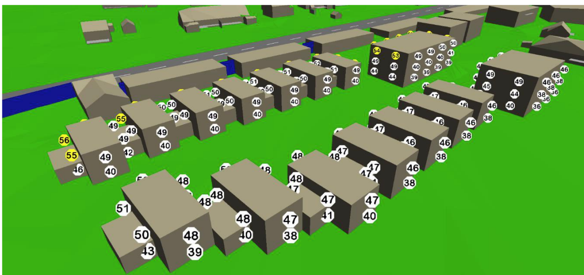
Figur 35: Innfallende lydtryknivå L_{den} på fasader fra veitrafikk. Sett fra vest og vist med skjerpet grenseverdi
