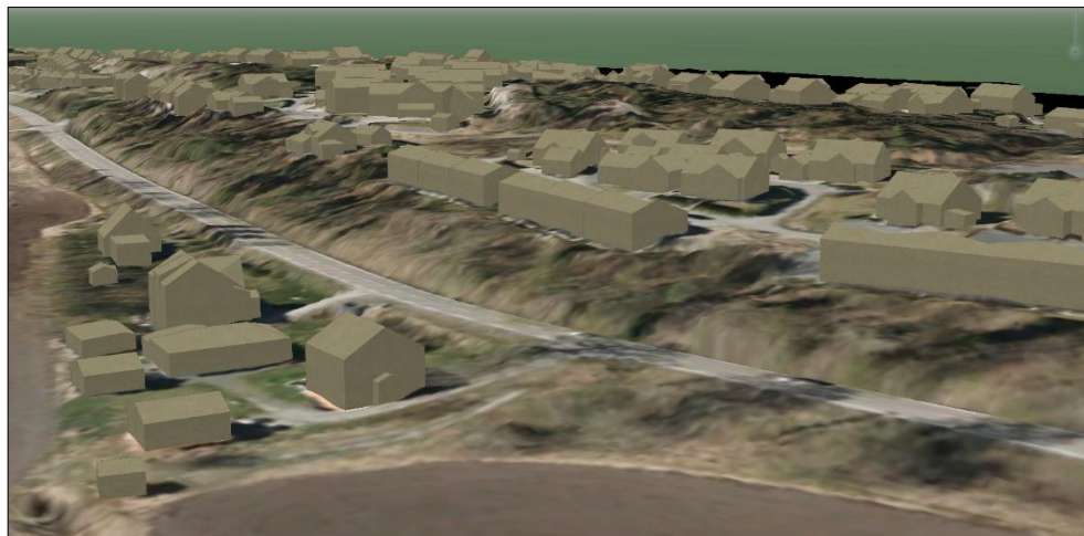
Figur 22 Illustrasjon fra 3D-modell: Eksisterende terrengforhold langs skråning vest for Larkollveien (profil ca 655-1165, ref. teknisk plan). Sett mot sørvest. Kilde: COWI AS.
