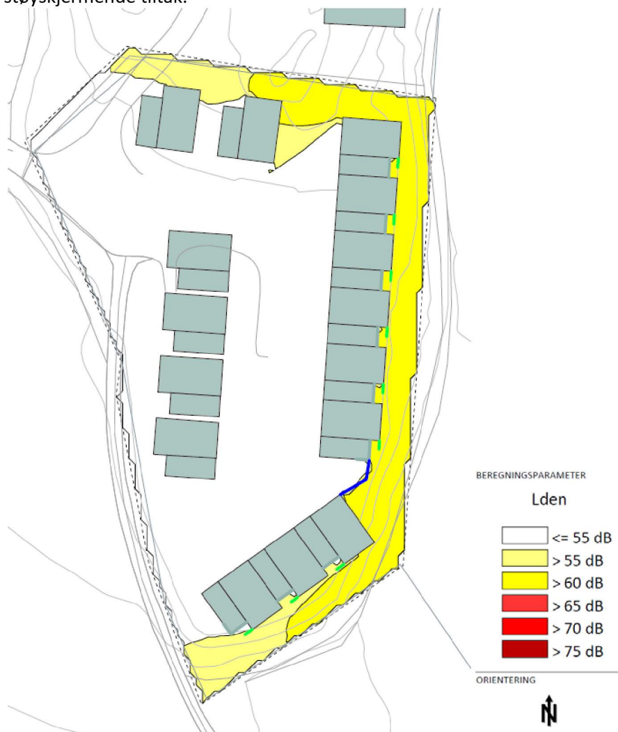
Figur 5 Utdrag fra vedlegg X002 - Støynivå på uteoppholdsareal med støy fra veg, beregnet i 1,5 m høyde. Støyskjerm i sør markert i blått. Lokalskjermer ved vindu i 1. etasje markert med grønt.
