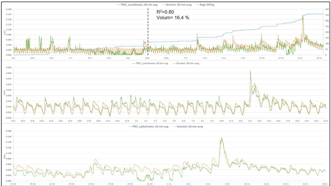
Figur 18: Kalibreringsgraf for SID 7901 Larkollveien. Grønn=målt, oransje=simulert, blå=regn
