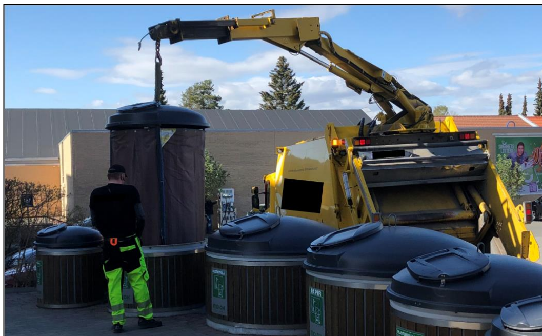
Figur 20 Eksempel på tømming av avfallsbrønner med renovasjonsbil med kran (foto: Sweco AS).
