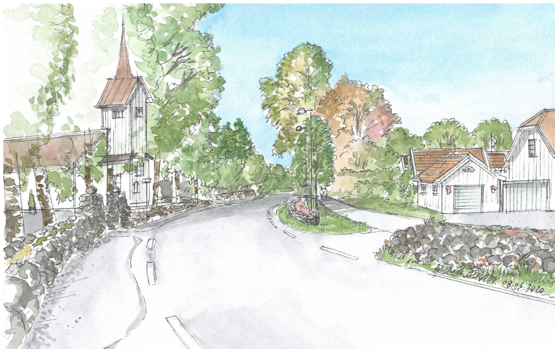
Figur 18 Skissen viser planlagt løsning med gang- og sykkelvei på vestsiden av steingjerdet, og med trerekke i rabatt mellom gang- og sykkelvei og kjørevei.
